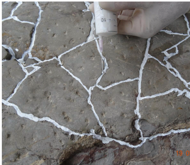
图 7 无水微米-纳米石灰注浆加固开裂石灰岩研究
