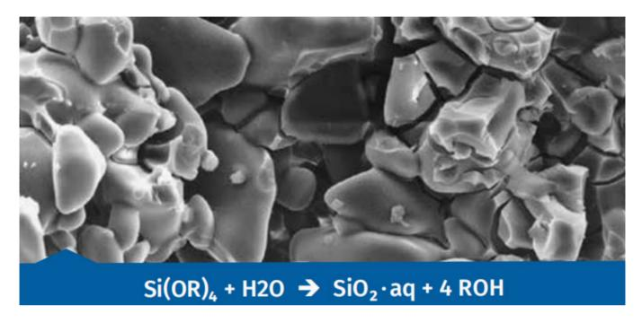
硅酸乙酯本身是一种液体, 所以原则上可以在不添加溶剂的情况下将其渗入孔隙结构中。通过改变大分子和小分子的混合比例, 可以有针对性地改变固化剂的特性, 特别是其凝胶生成率, 即在孔隙结构中形成的硅胶量。
