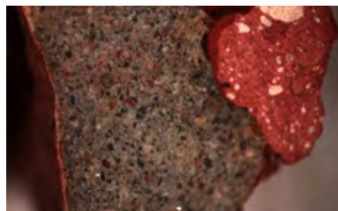
图4b 外立面采用的水泥平缝断面（放大65倍）
