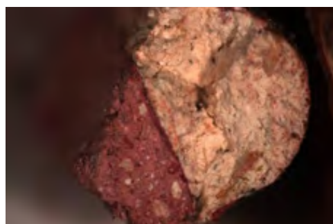
图4a 外立面残留元宝缝断面（放大65倍，底部存在红色勾缝剂）
