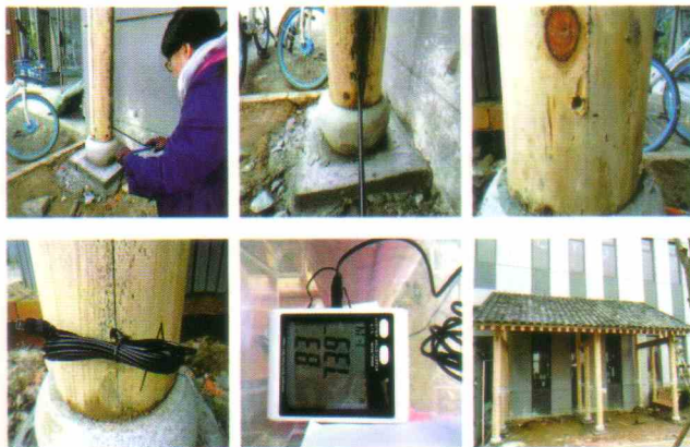
图6 木柱本体温湿度监测(图片来源:作者自摄)
