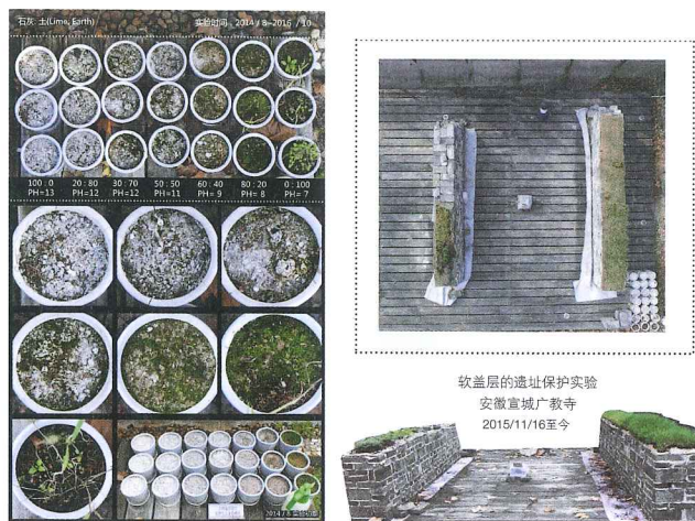
图5 同济大学历史建筑中心实验室 2014 年 8 月开始为阐明屋面苔背材料对屋面耐久性的影响而进行的不同苔背材料植物生长实验（左）；同济大学历史建筑中心实验室 2015 年 11 月为安徽宣城广教寺遗址的保护所进行的“软盖层”保护自然实验研究（右）
