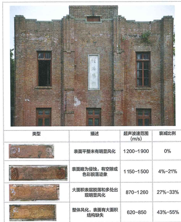
图3 之江大学钟楼立面不同劣化程度的黏土砖与超声波波速之间的关系 图片由周月娥提供
