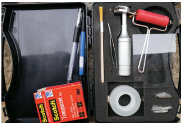
同济大学历史建筑保护实验中心自主研发的半定量测定砖石灰等材料表面粉化的仪器
